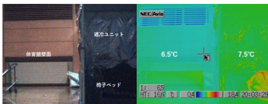
図-9 遮冷ユニット内外の表面温度差
