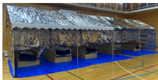
図-1 遮冷ユニットの外観
