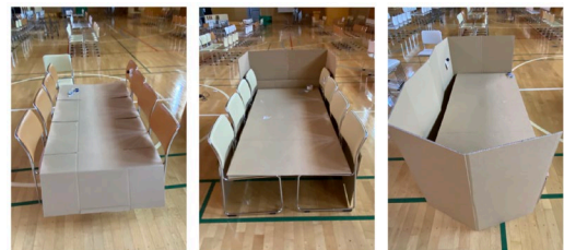
図-3 実験時の簡易ベッドの様子(左:椅子ベッド囲いなし,中央:椅子ベッド囲いあり,右:段ボールベッド)
