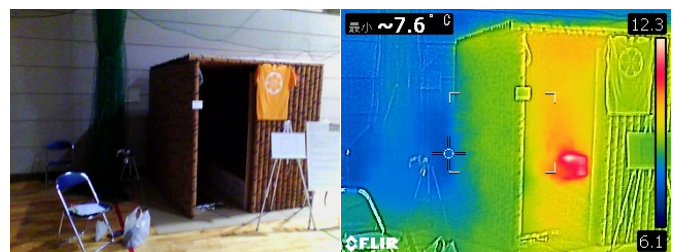
図 6 紙管シェルターとその周辺の熱画像(5:00 撮影)
